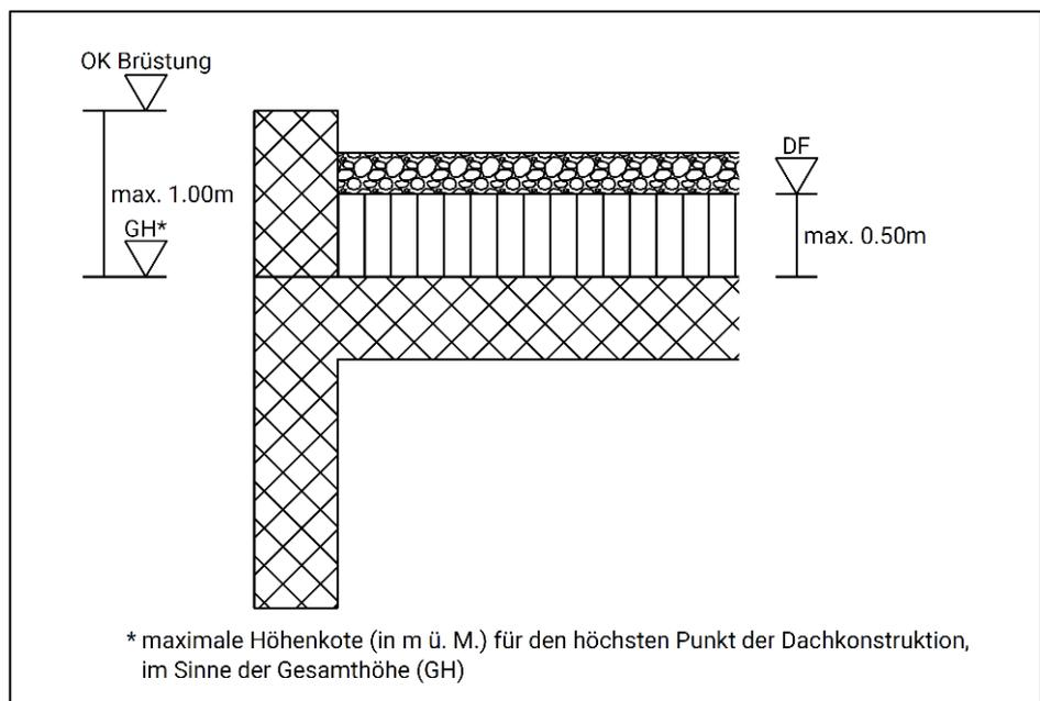
**Abb. 5:** Skizze Messweise der Gesamthöhe (GH), Dachfläche (DF) und Brüstung (OK Br)
