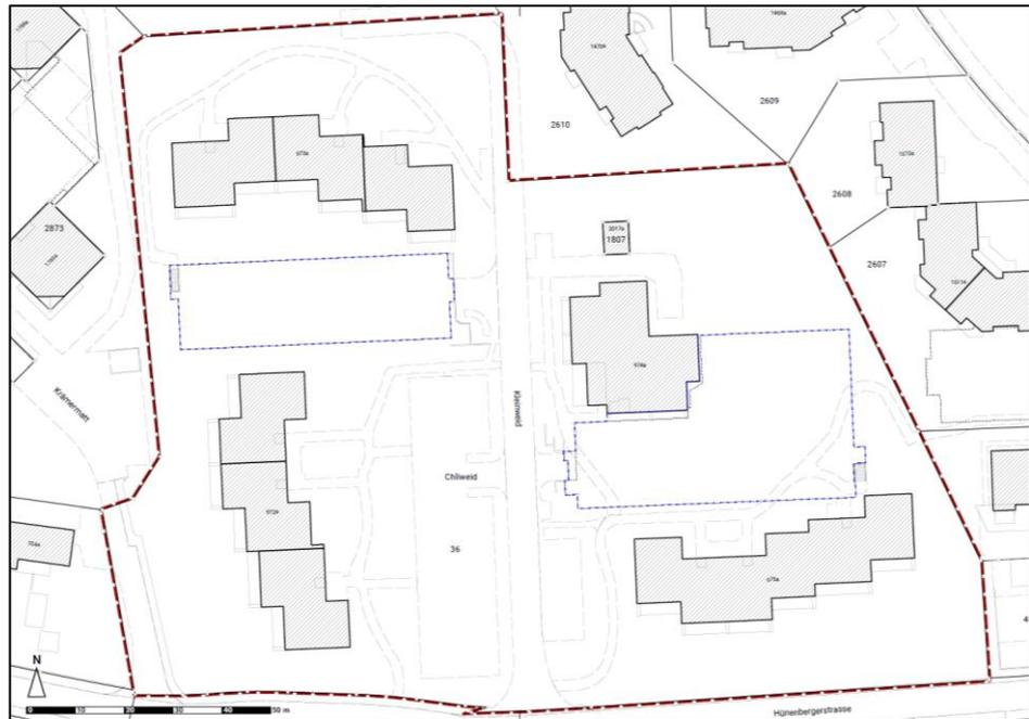
**Abb. 7:** Differenzplan Baubereiche für Tiefgaragen und Unterniveaubauten Kleinweid. Vergleich rechtskräftiger und überführter Bebauungsplan
