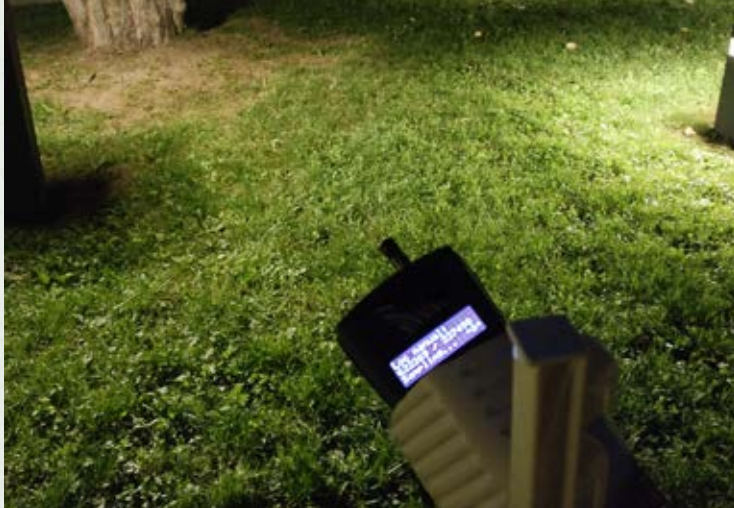
Aufgrund der Ruffrequenz, die mit einem speziellen Aufnahmegerät gespeichert wird, kann im Nachhinein die Art der Fledermaus bestimmt werden.
